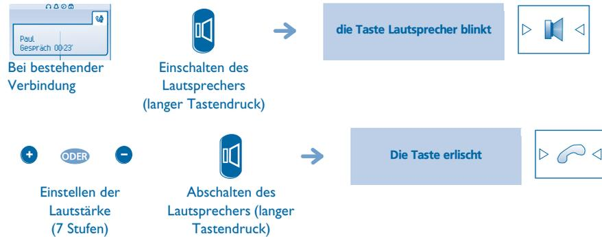
Ein kurzer Druck auf die Lautsprechertaste ermöglicht den Übergang in die Betriebsart Freisprechen (Anzeige leuchtet ständig).
