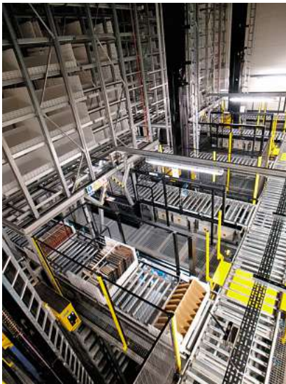
British Library, ASB (Additional Storage Building), Boston Spa: Förderanlage für den Transport aus den Hochregalen
