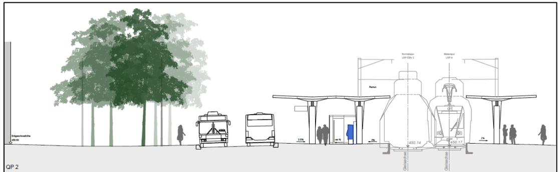
Abbildung 2: Querschnitt Bahnhof Mattenhof mit gestaltetem Perrondach
