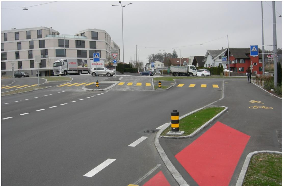
*Foto 2: K 13 Seite Neuenkirch; Einfahrt und Ausfahrt Kreisel mit je einem Bypass*
